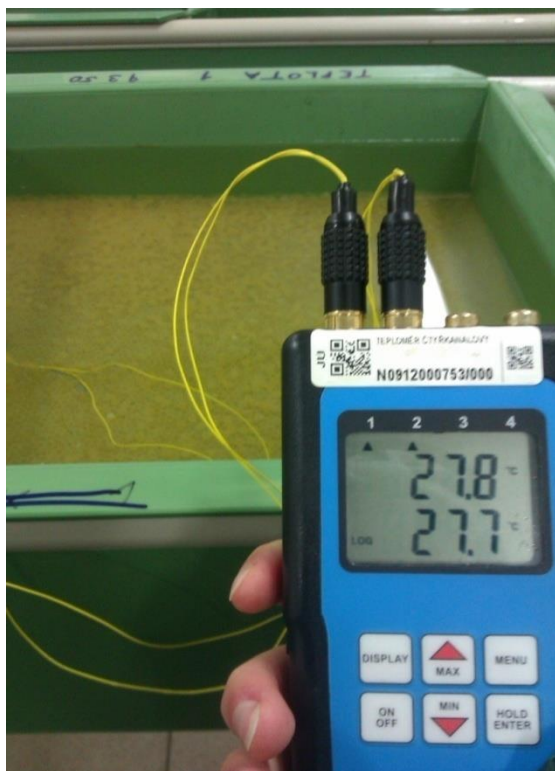
Příloha č. 5 : Měření teploty vody u vložky s indukcí teplého šoku (Foto: autor).
