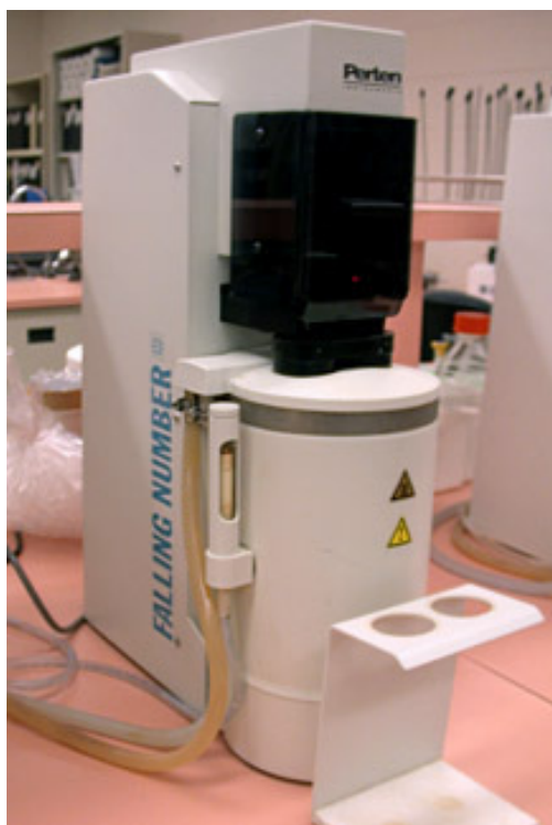
obr. 9 Na přístroji Falling number (dříve amylograf) je zobrazována hodnota čísla poklesu v sekundách.
