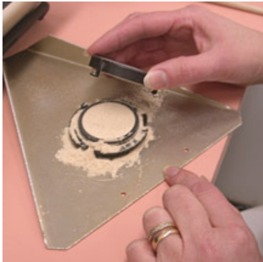
obr. 3 Nejprve se provede test vlhkosti u rozemletého vzorku, který byl vybrán ke stanovení.
