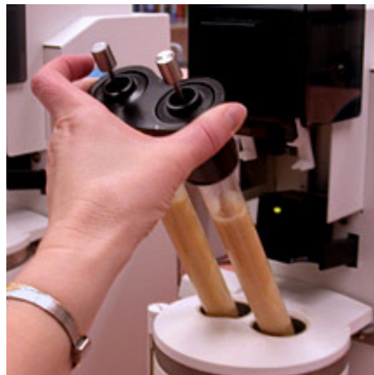
obr. 8 Zkumavky obsahující „kaši“ jsou ponořeny do vodní lázně, která je na bodu varu. Kaše z pšeničného šrotu a vody je míchána do doby, dokud se od sebe tyto dvě složky neoddělí.
