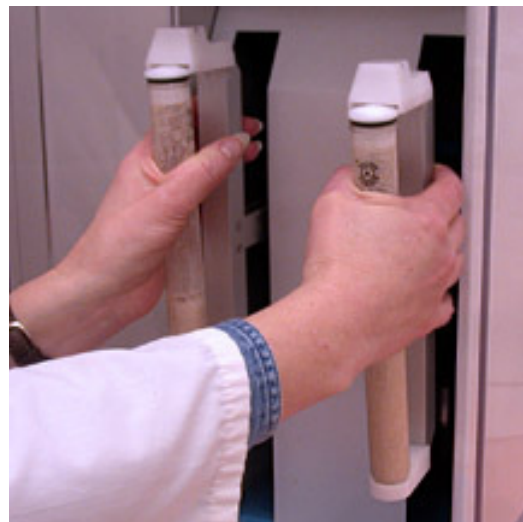
obr. 6 Vzorek pšenice s vodou se protřepe ve speciálních držácích. Ve zkumavce se vytvoří kašovitá hmota.
