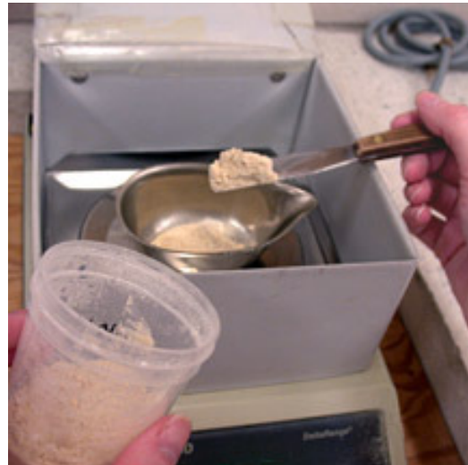
obr. 4 Navází se přibližně 7g vzorku, který byl upraven na vlhkost 14%. Takto upravený vzorek se může použít ke stanovení.
