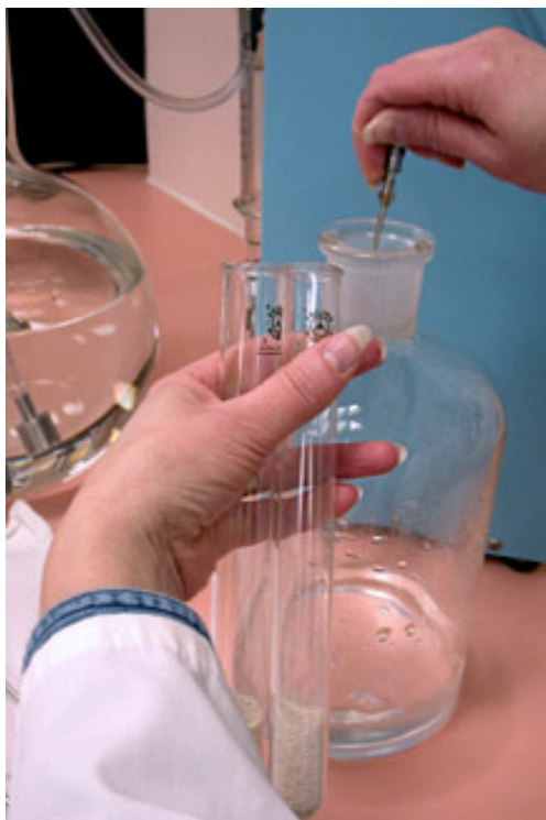
obr. 5 Do zkumavky určené pro Falling number test se ke vzorku přidá destilovaná voda.
