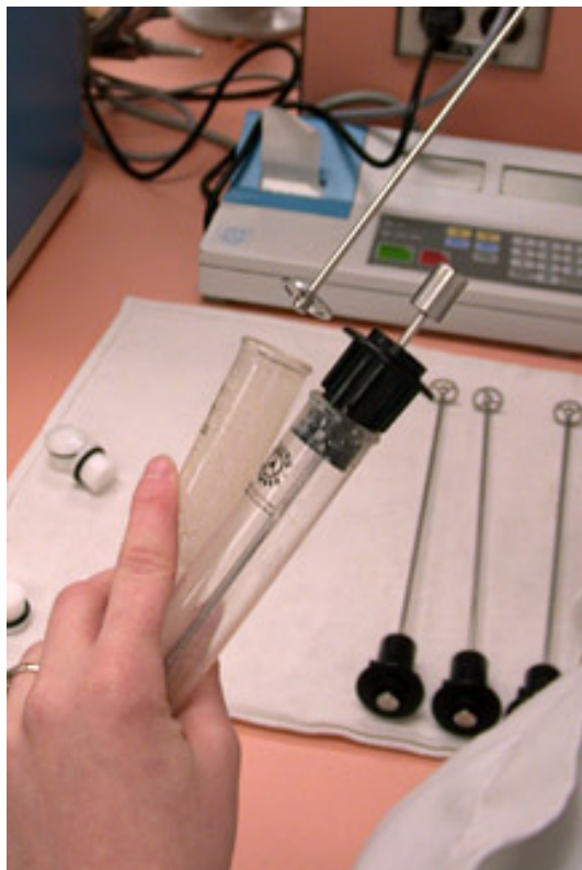
obr. 7 Do každé zkumavky pro Falling number test je umístěno míchadlo.
