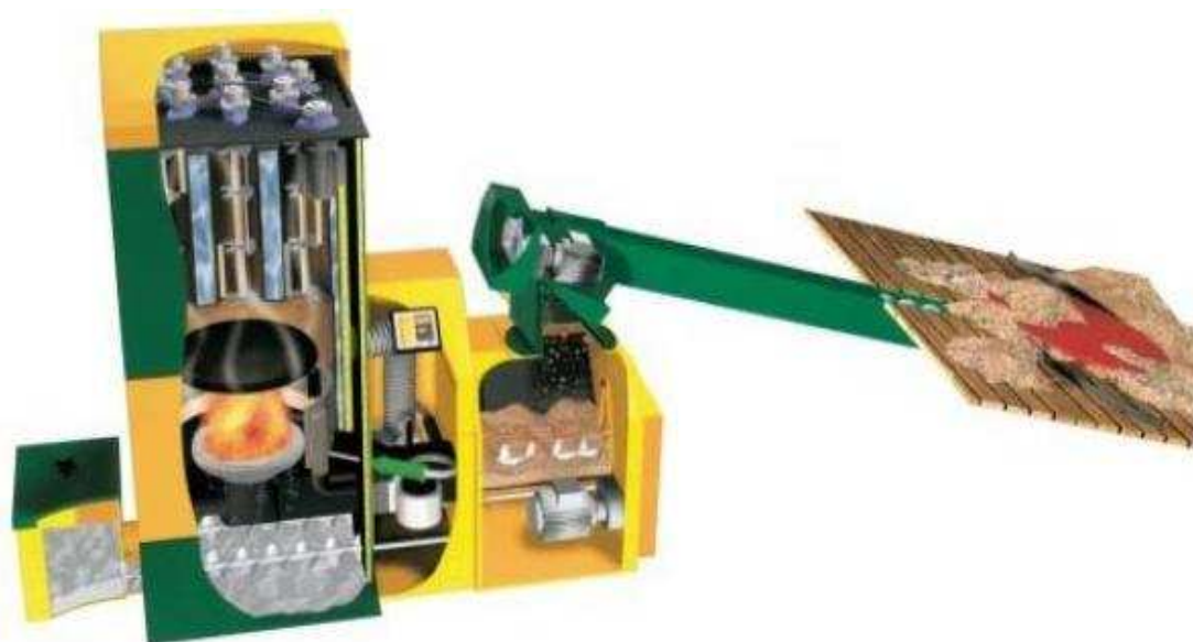
Obrázek 1.2 - Schéma automatického kotle na drobnou štěpku
