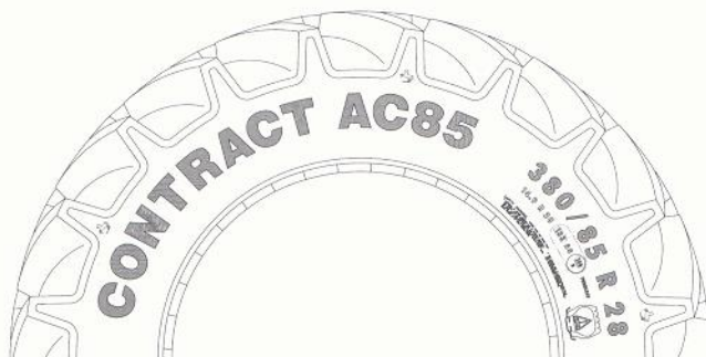
Uspořádání popisu pneumatiky AS-radial 380/85 R 28 (14,9 R 28) 133 A8 ContiContract AC 85
