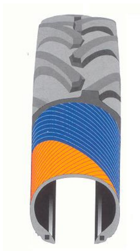
Obrázek 12 Konstrukce diagonální pneumatiky
