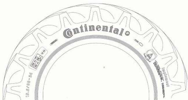
Uspořádání popisu pneumatiky pro Implement 15,5/80 – 24, 145 A6 ⊕, 157 A6 ⊕ 12 PR AS-Farmer
