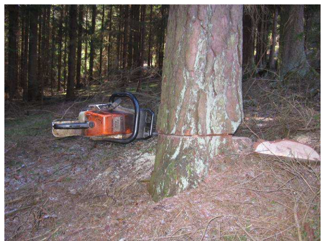
Obrázek 27 – Sevření motorové pily ve kmeni stromu
