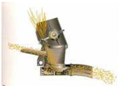
Obrázek 70 - Trychtýřový rozmetač slámy
