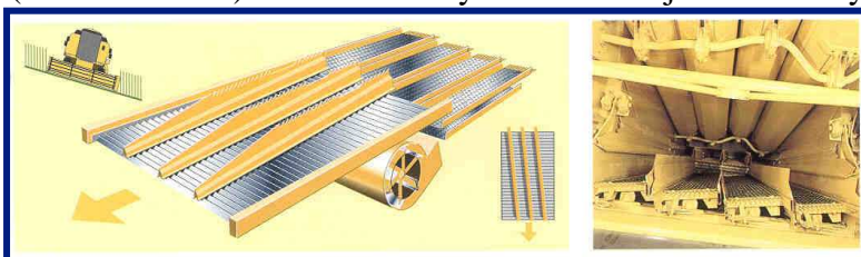
Obrázek 62 - Svahové vyrovnávání čistidel New Holland CS
