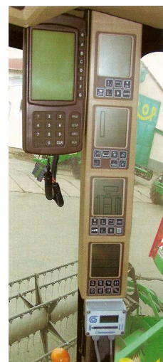
Obrázek 81 - Kontrolní sloupek John Deere
