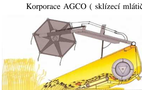
Obrázek 12 - Schéma žací lišty Power Flow
