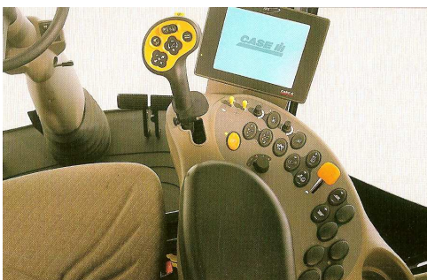
Obrázek 80 - Ovládací postranní konzola Case AXF 8010
