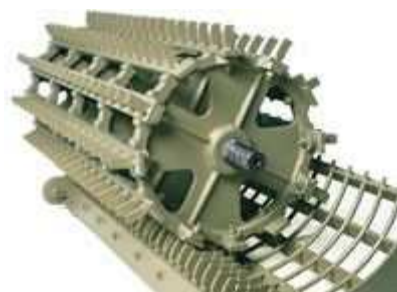
Obrázek 32 - Hřebový mláticí buben
