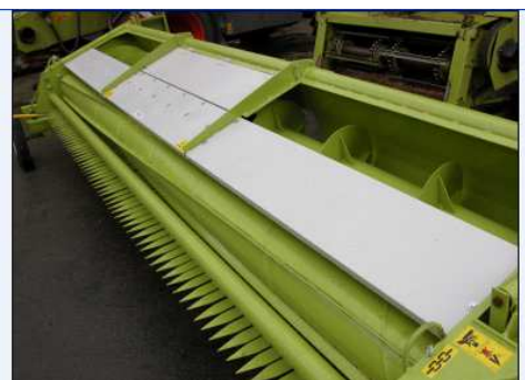
Obrázek 22 - Adaptér pro sklizeň makoviny SOROKO SMG - 600
