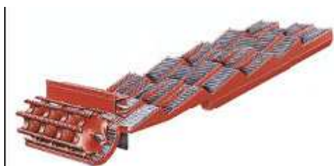
Obrázek 42 - Stupňovité klávesové vytrásadlo
