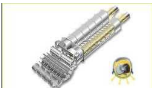
Obrázek 48 - CLAAS HYBRID SYSTEM samostatném separačním koši. Sloučením APS a ROTO PLUS vznikl CLAAS HYBRID
