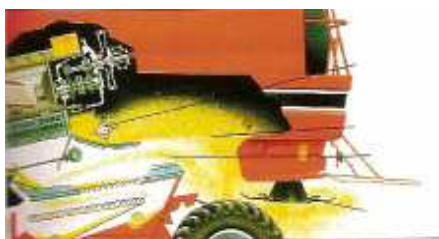
Obrázek 68 - Princip drcení Case Axial Flow
