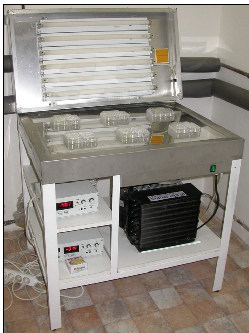
Obr. 3: Ilustrační foto gradientového stolu. Na této fotografii je světelný zdroj umístěn na boční straně stolu, pro svůj pokus jsem používala zdroj umístěný nad stolem, který se nevešel do záběru.
