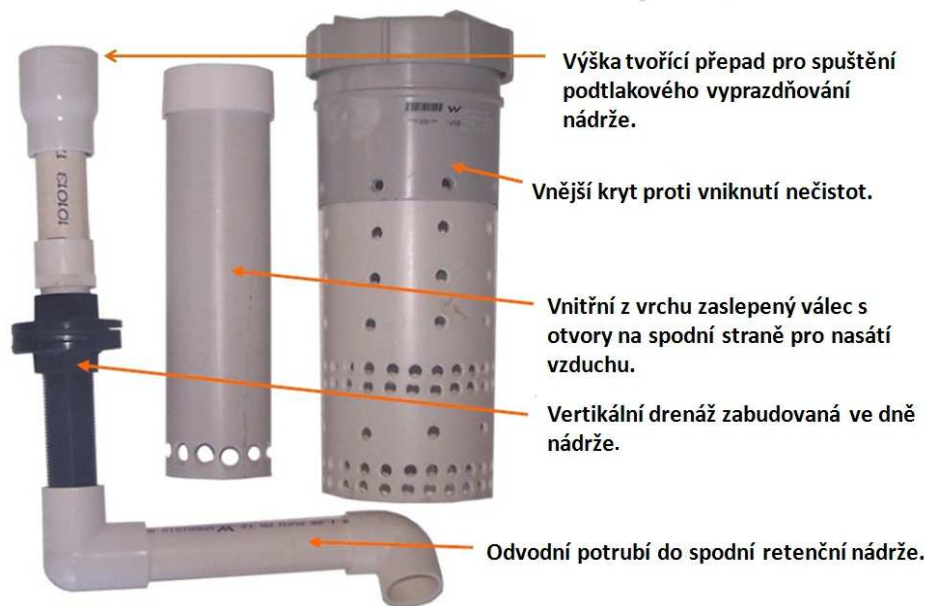
Obr. 7. Autosifon, spolehlivý spouštěč periodického zaplavování (upraveno podle Hallam, 2014)
