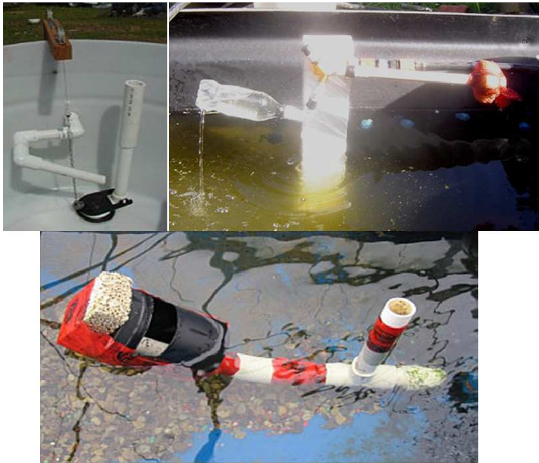
Obr. 6. Možná technická řešení zařízení pro spuštění periodického zaplavování (Tezel, 2009)
