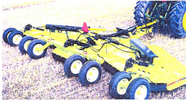
Obr.5.6 - Mulčovač srpového, krouživého či talířového typu s vertikální osou otáčení pracovních nástrojů nožů
