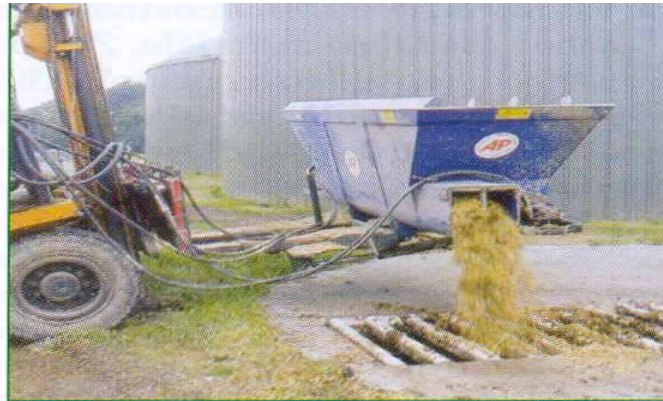
Obr 6.2, 6.3 - Kofermentační bioplynové stanice, plnění odpadní biomasou
