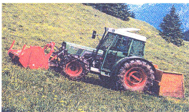
Obr.5.4 - Čelní zavěšení cepového mulčovače menšího záběru firmy Humus je výhodné zvláště na svažitých plochách v horských oblastech
