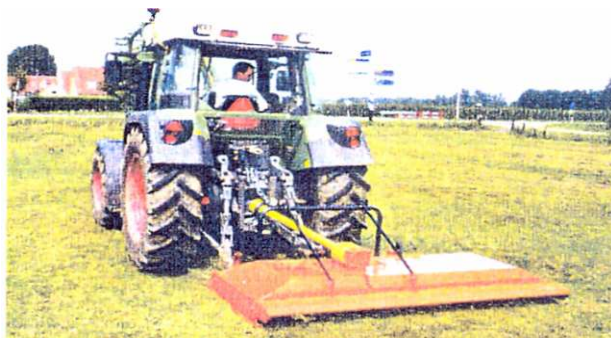
Obr.5.3 - Krouživý mulčovač s detailem proveden pracovního ústrojí od firmy Perfect van Wamel dosahuje vysoké pracovní rychlosti až 10 km/h
