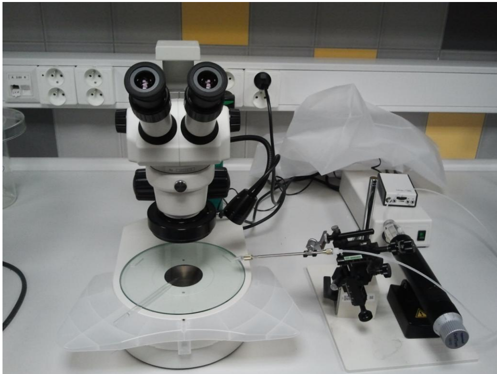
Obr. 5: Micromanipulátor M-152 (Narishige, Japonsko) a microinjektor CellTram Vario (Eppendorf, Německo) a fluorescenční stereomikroskop M165FC (Foto: Petr Dobrovolný).
