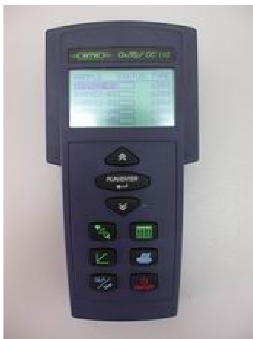
Obr. 12 Řídící jednotka OxiTop® OC110 .
