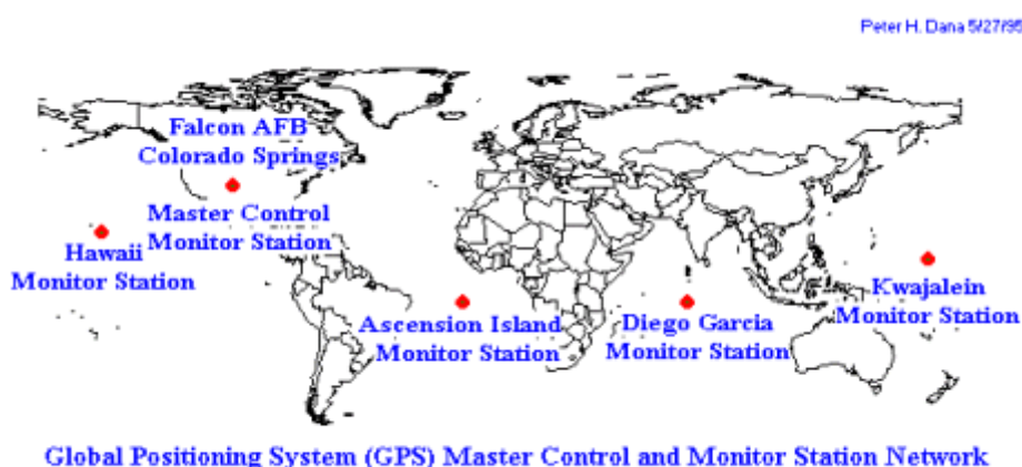
Obr.5: Monitorovací stanice systému GPS
