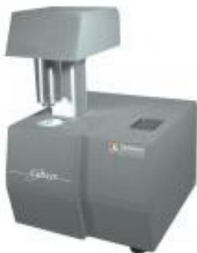
Obr. 10 Přístroj LABSYS, na kterém byly stanovovány charakteristiky DTA
