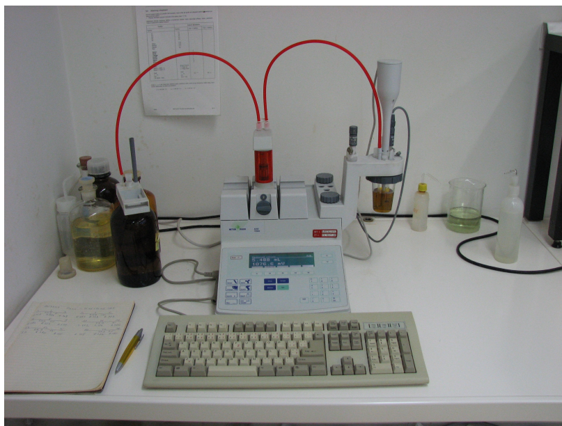
Obr. 8 Titrátor METTLER TOLEDO DL-50 při stanovování vzorku
