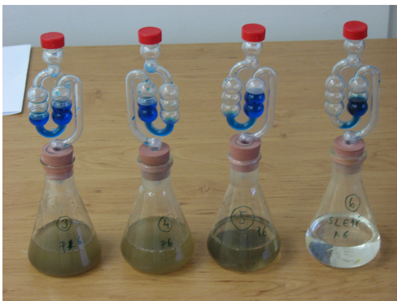
Obr. 6 Série baněk s vinnou zátkou použité pro anaerobní rozklad připravené se vzorky půdy na vložení do termoboxu
