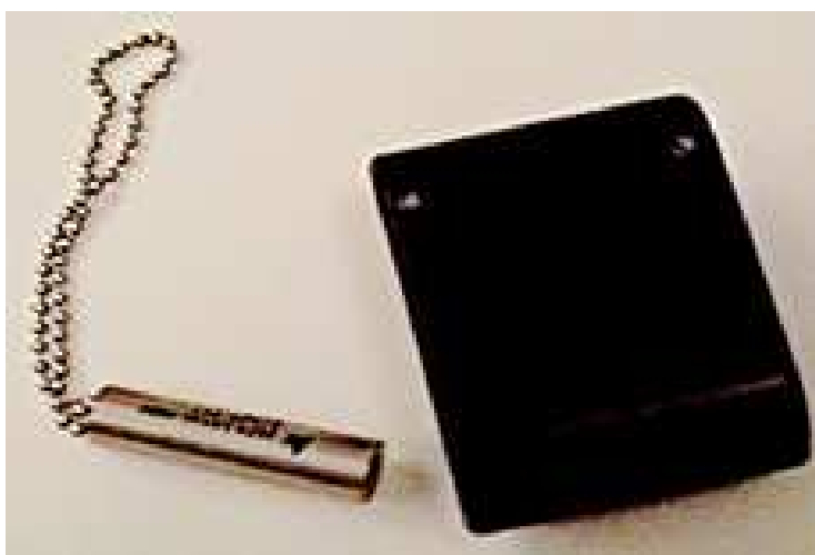
Obrázek 6. Magnet na aktivaci activity metru a activity metr
