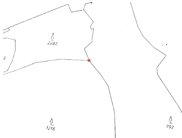
Obr. č. 9: Vhodné použití mezníku na vlastnické hranici jako vlčovacího bodu
