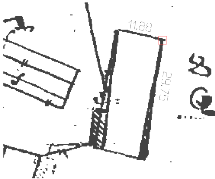
Obr. č. 11: Identický bod na rohu budovy
