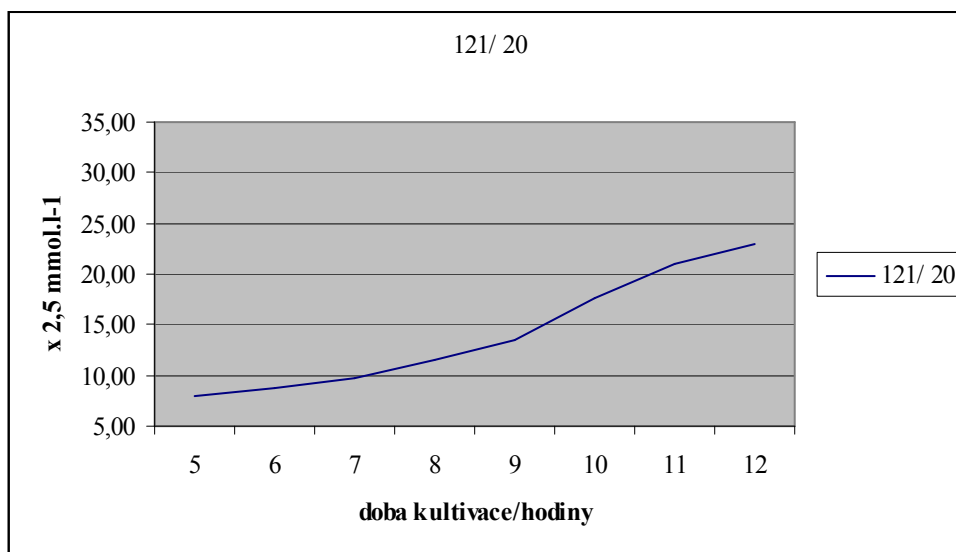
Graf 17: Průměrné hodnoty* změn titrační kyselosti při prokysávání standardního mléka (ošetření 121°C/3s, kultivace 20°C) naočkovaného smetanovou kulturou CHN 22.
