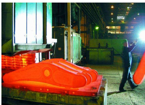
Obr. 4: šasí pro kolejový podvozek
