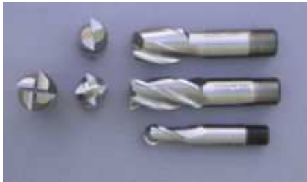
Obr. 12: Používané stopkové frézy při obrábění
