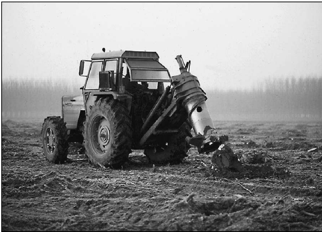
Obrázek A. 7 – Mechanizovaná likvidace pařezů RRD
