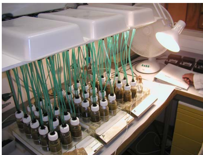
OBRÁZEK 2: Zařízení na provedení in vitro plynové produkce
