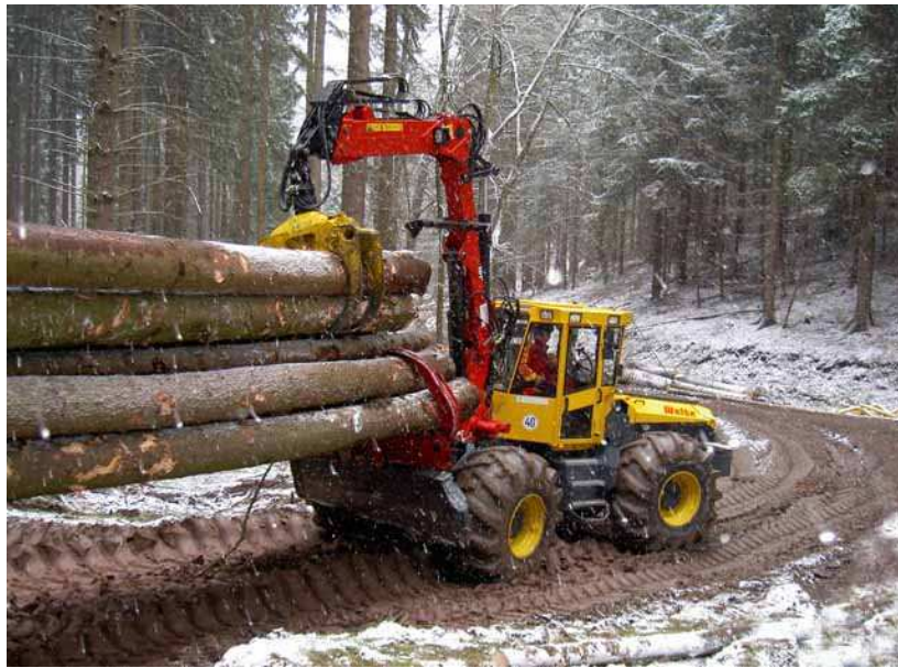
Obrázek 5: SLKT s drapákem a svěrným oplénem Welte W 180
