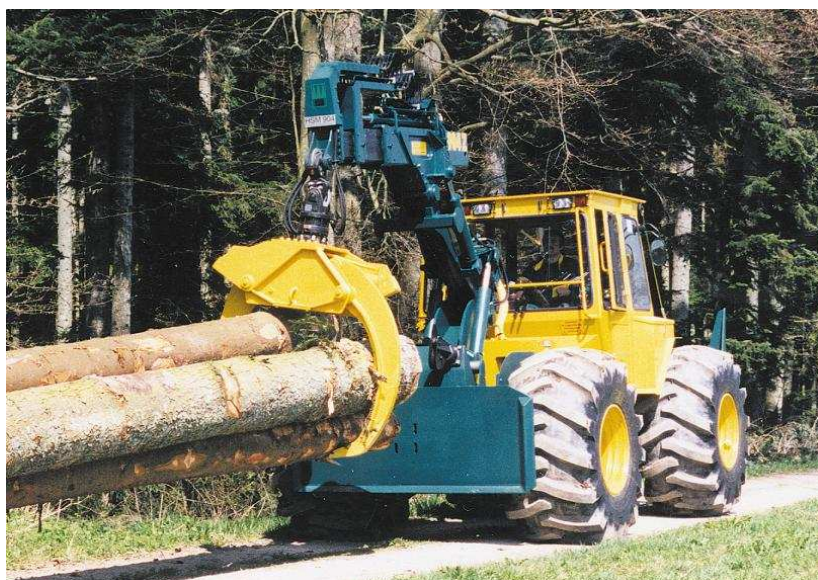
Obrázek 4: SLKT s krátkým jeřábem a velkým drapákem HSM 904 Z
