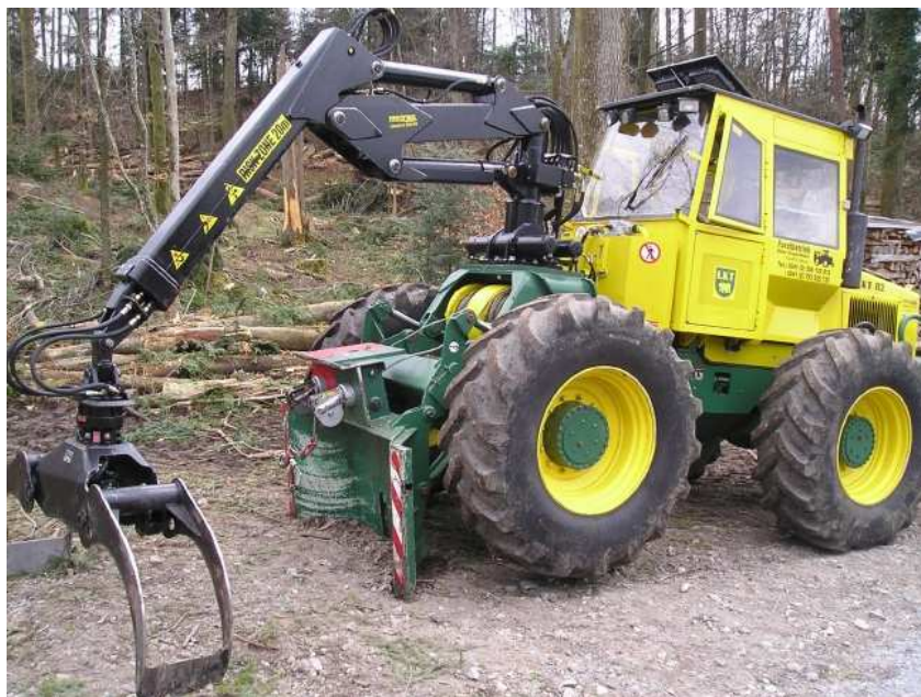
Obrázek 2: SLKT s navijákem, štítem, radlicí a jeřábem LKT 82 C
