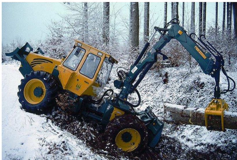
Obrázek 3: SLKT s delším jeřábem HSM 904 H
