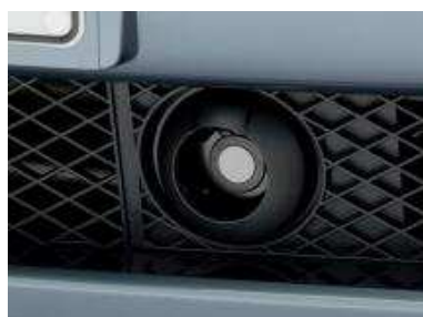
Obrázek 15 - umístění FIR kamery v předním nárazníku Zdroj: www.autoweb.cz
