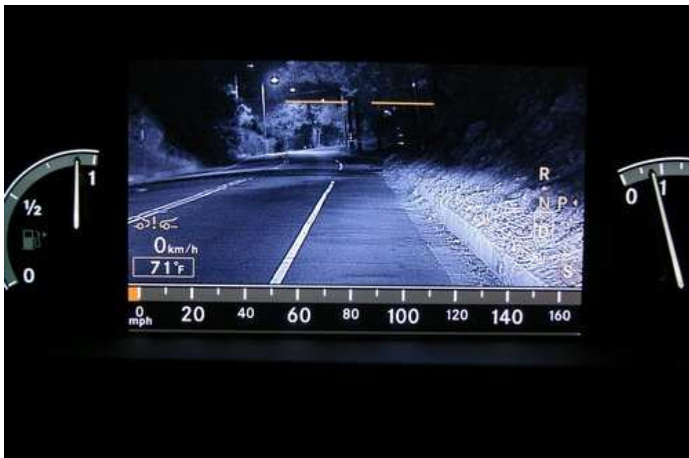
Obrázek 17 - systém nočního vidění zobrazující vozovku na obrazovku v přístrojové desce Zdroj: cars.about
