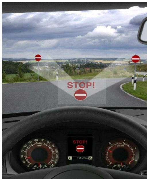
Obrázek 12 - čtečka značek Opeleye s využitím technologie virtuálního obrazu Head-up Display
