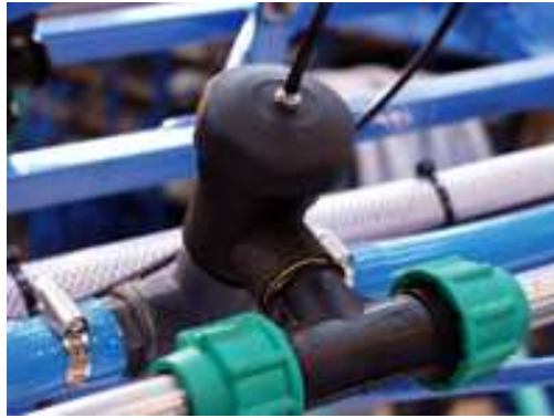
Obrázek II - 11: Vzduchem vypínaný rozvod jíchy [7]
