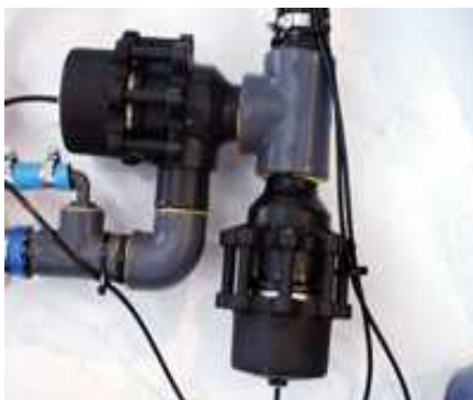
Obrázek II – 7: Dálkové ovládání změny dávky [7]
