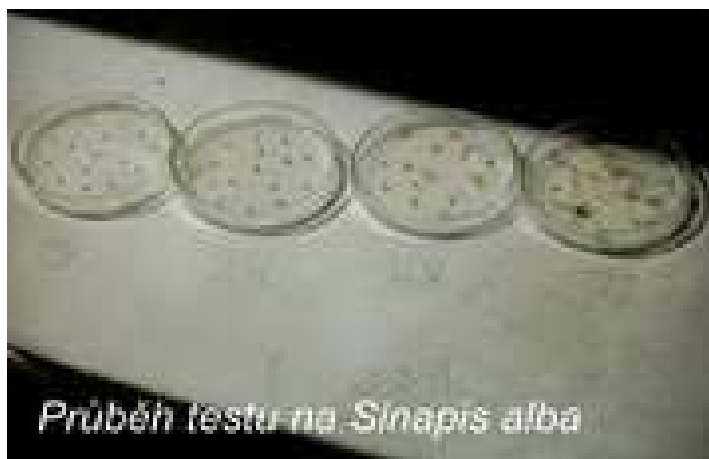
Obr. 1a: Průběh testu akutní toxicity na semenech hořčice bílé ( Sinapis alba ).
