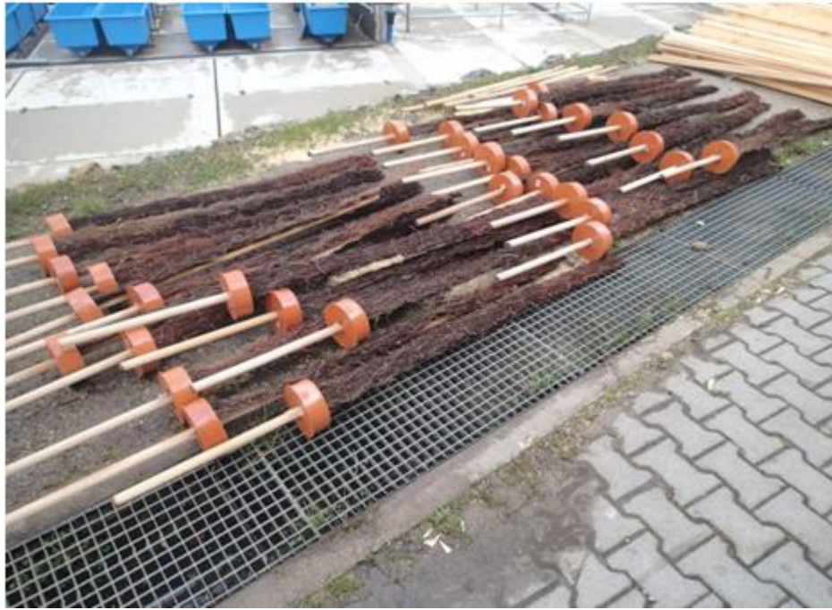
Obr. 5: Pruhy substrátu (vřesovec) na odběry substrátového zoobentosu, připravené k umístění do rybníků na pokusnictví VÚRH ve Vodňanech (foto: Bláha, 2014).
