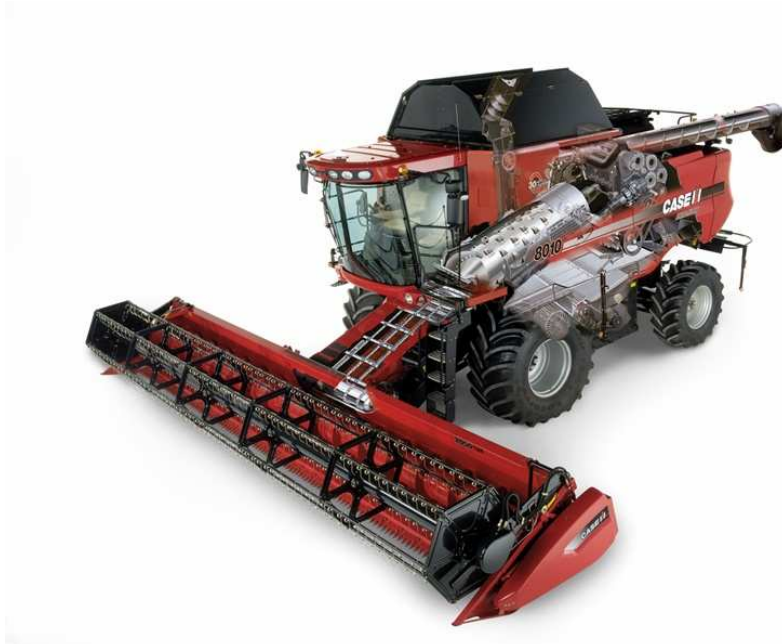
Obrázek 2-4 – Axiální sklízecí mlátička Case IH AFX 8010
