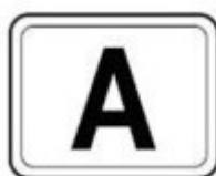
OBR. 15 – OZNAČENÍ NÁKLADNÍCH AUTOMOBILŮ S ODPADY
