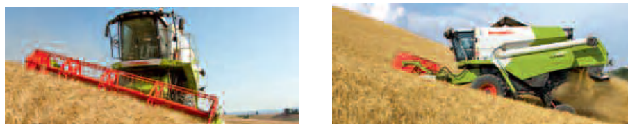
Obrázek 25 – Příčné a podélné vyrovnávání sklízecí mlátičky Claas Tucano v modifikaci Montana
