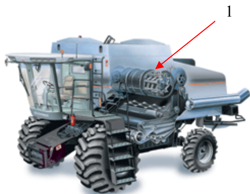
Obrázek 11 - Agco Gleaner R65 s příčným axiálním rotorem (1)
