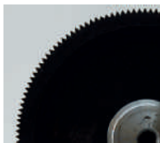
Obr. č. 31: válec se 144 zuby
