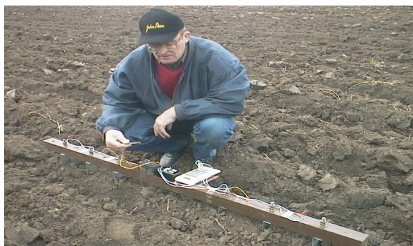
Obrázek 4 – Senzor pro měření vodivosti kontaktním způsobem [15].
