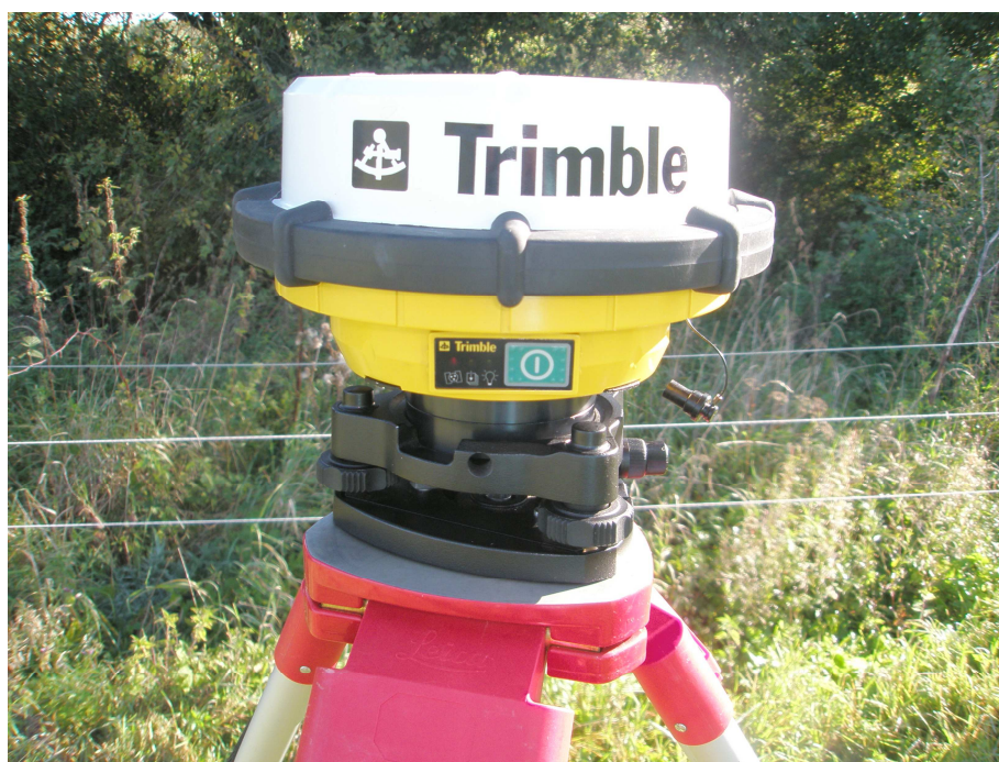
foto. 5: GPS aparatura Trimble 4600LS při měření na bodě 716
