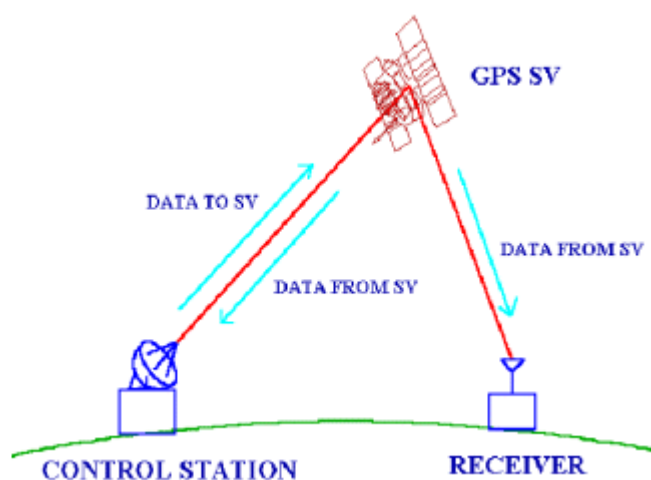
Obr. 7: Příjem signálu a zpětné vysílání s opravenými daty [2]
