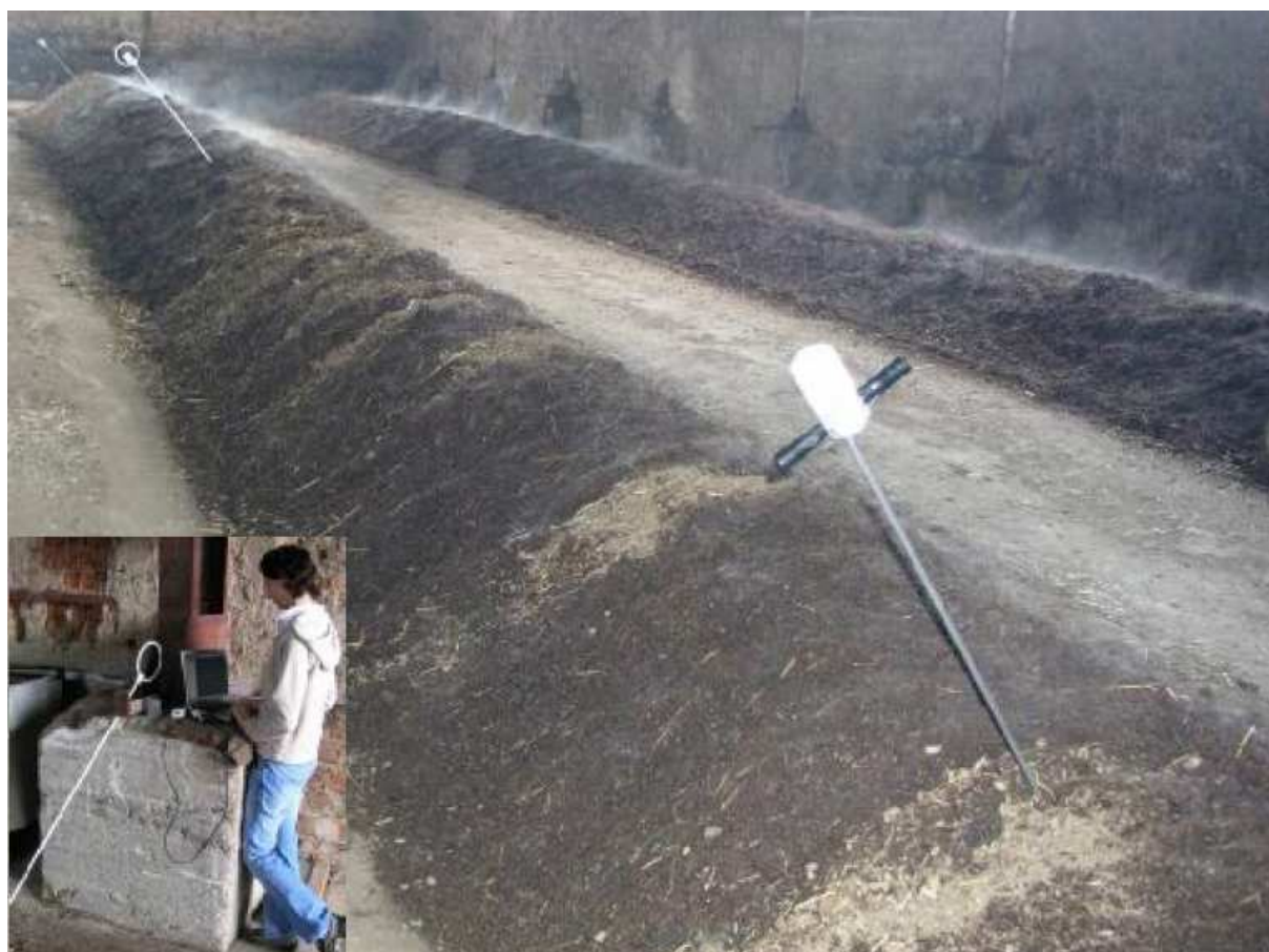
Obr. č. 10 Zapichovací teploměr se záznamníkem naměřených hodnot
