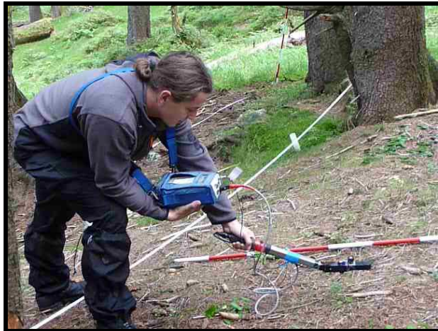
Obr. 6: Měření množství dopadajícího slunečního záření na TVP Modrý důl (foto: F. Havlíček)
