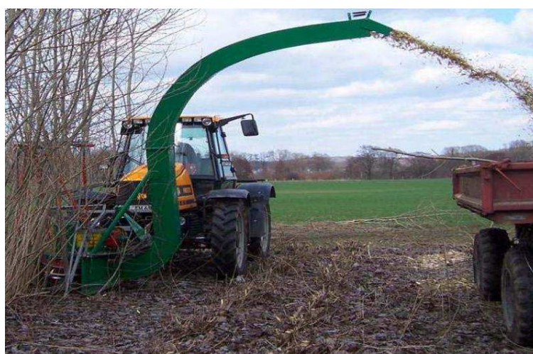
Obrázek 3.20 – Přídavný adapter na traktor s možností kácení a štěpkování
