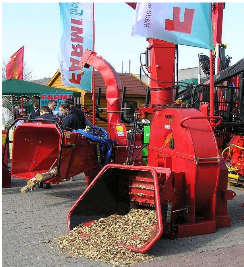
Obrázek 3.3 – Nesený diskový štěpkovač FARMÍ 380
