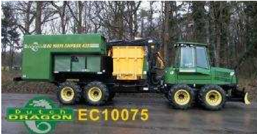
Obrázek 3.7 – Štěpkovač EC-10075 umístěný na podvozku vyvážecí soupravy
