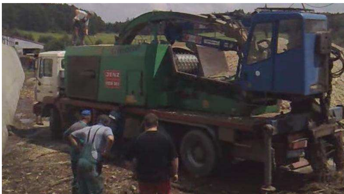
Obrázek 3.6 – Štěpkovač JENZ umístěný na podvozku nákladního automobilu
