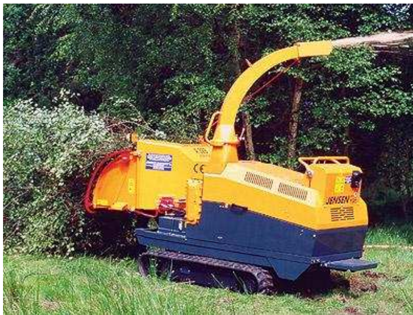
Obrázek 3.5 – Bubnový štěpkovač Jensen 410 na samostatném podvozku
