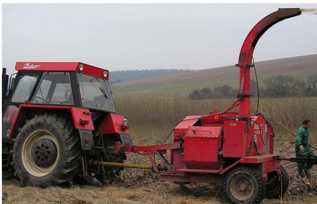
Obrázek 3.4 – Přívěsný bubnový štěpkovač BOBR 7
