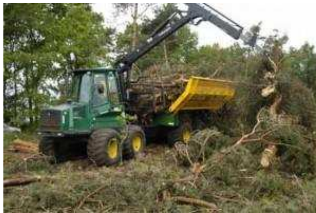
Obrázek 3.15 – Kompresní sběrač John Deere PC-48
