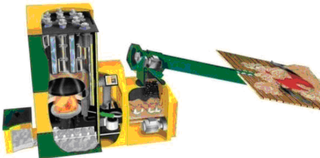
Obrázek 1.4 – Schéma automatického kotle na drobnou štěrku
