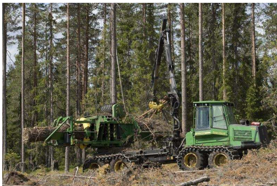
Obrázek 3.14 – Paketovací stroj John Deere 1490D
