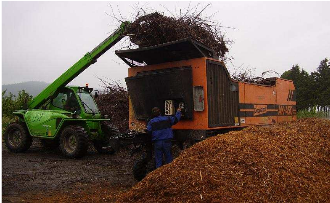
Obrázek 4.1 – Drtič Doppstadt AK 450 mega, nakladač Farmer
