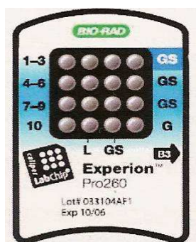
Obr. 6: Schématické znázornění analytického čipu Experion Pro260 (Bárta et al., 2009)
