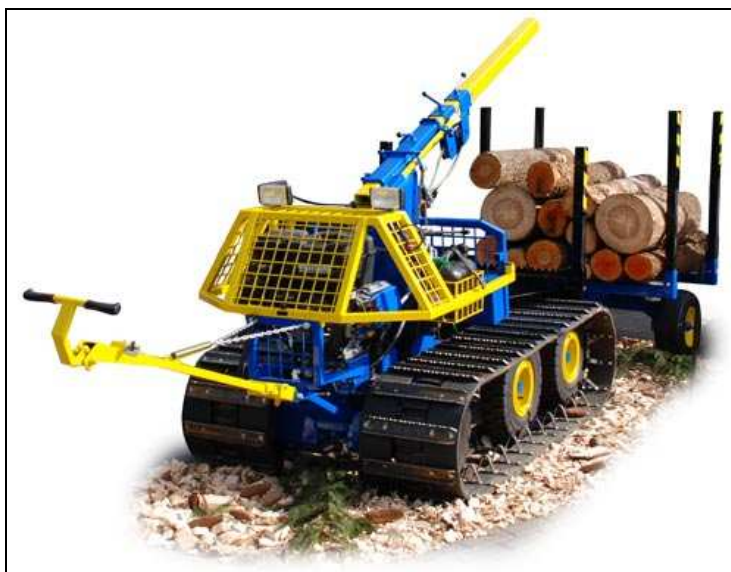
Obrázek 7: Pásové samohybné navijáky(železný kůň) KAPSEN (Zdroj: REPAROSERVIS, 2009)
