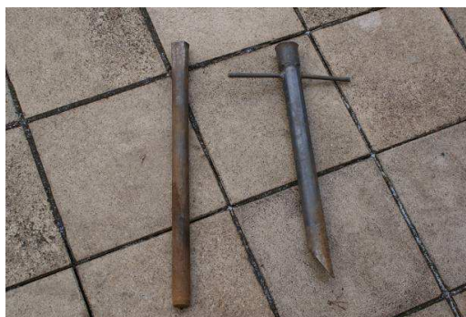
Obrázek 23: Sběrač půdních vzorků s vyrážecem (Foto: Vokáč)
