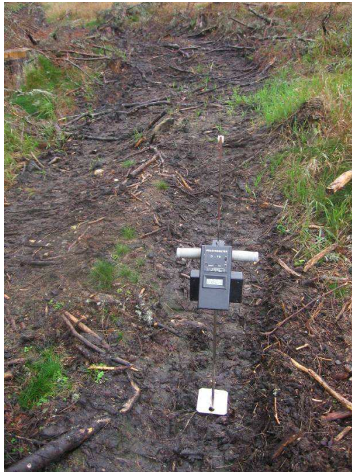
Obrázek 24: Měření utužení půdy penetrometrem v pravé stopě cesty (Foto: Vokáč)
