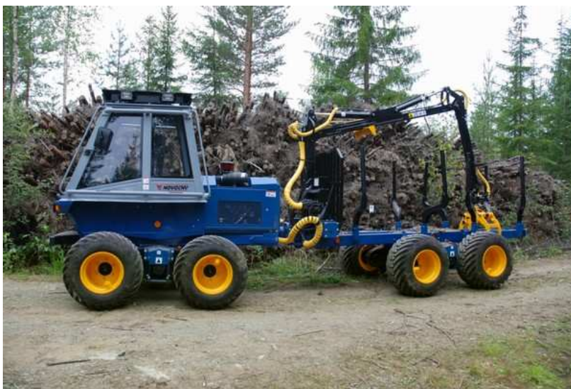
Obrázek 5: Malá vyvážecí souprava LVS 5 (Zdroj:LOADER.CZ, 2009)
