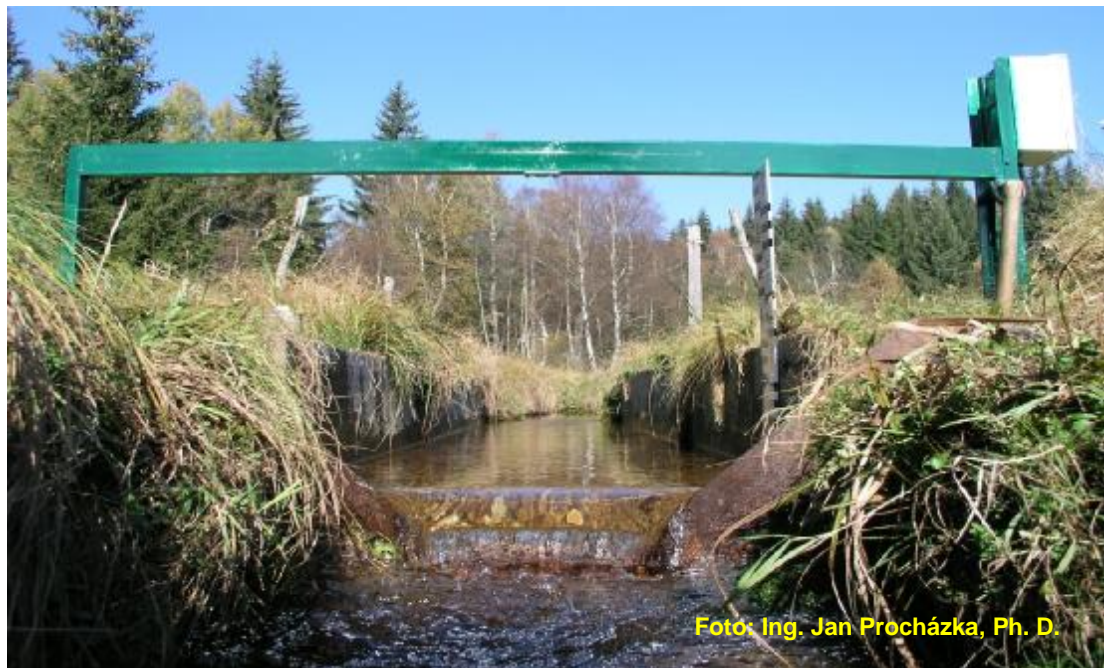
Foto č. 13: Měřicí stanice na Bukovém potoce – dřevěný obdélníkový profil s přepadem
