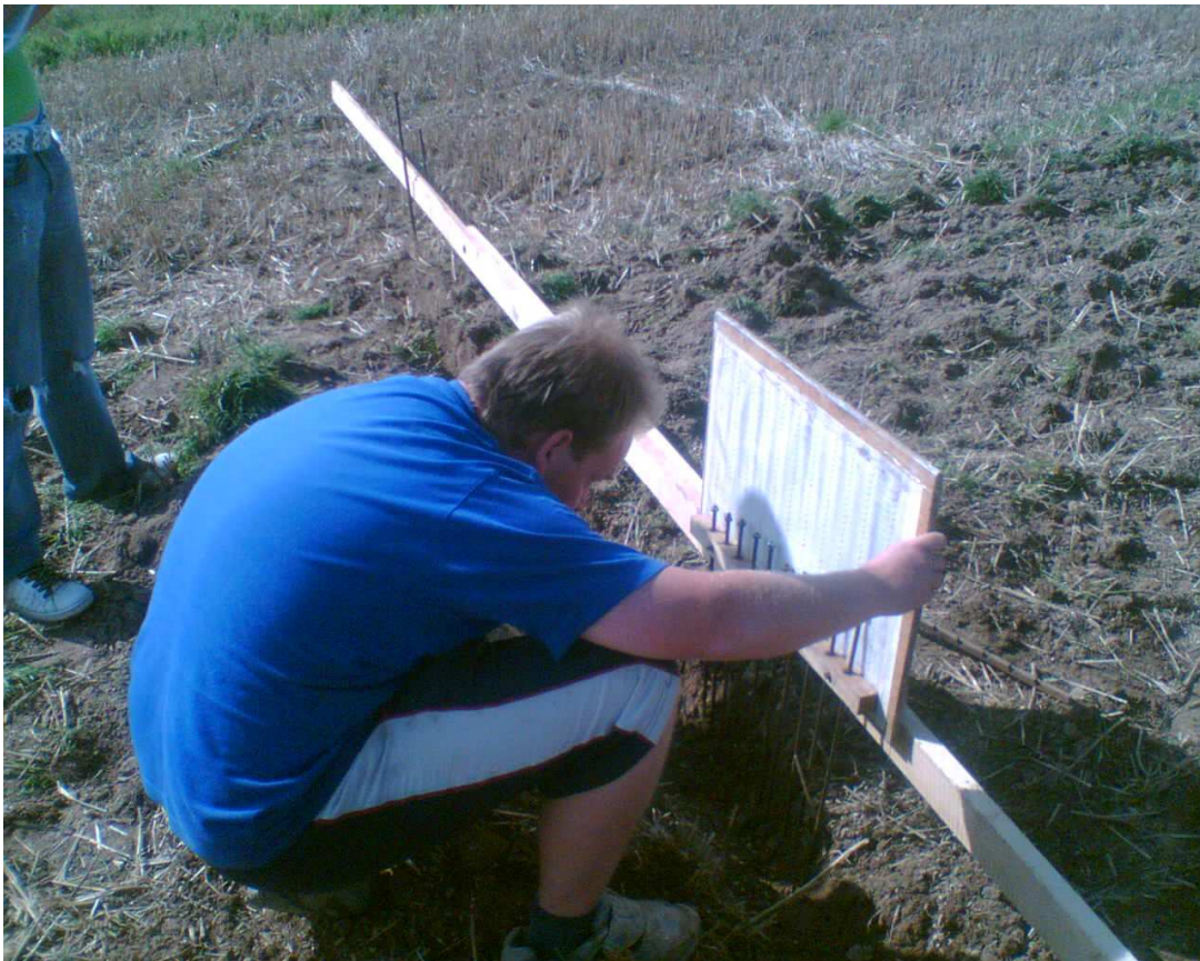
Obrázek 14-Měření zpracovávaného profilu a profil dna.
