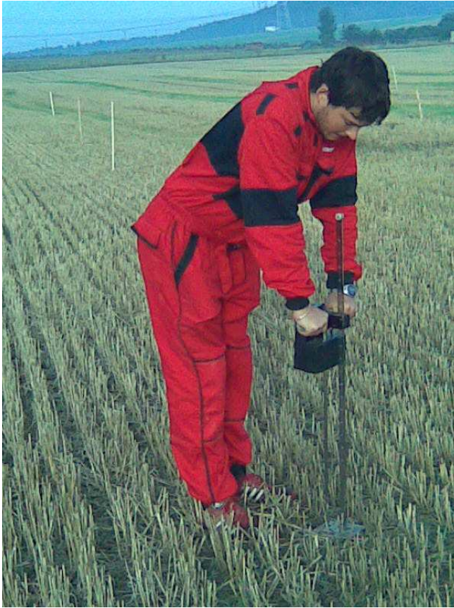
Obrázek 11-Měření penetrometrického odporu.
