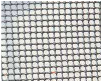
Obrázek 8-28 Tight-woven square mesh of rubber material (těsně tkané síťoví se čtvercovými oky gumového materiálu); příklad IMPULSE CARPNET RUBBER
