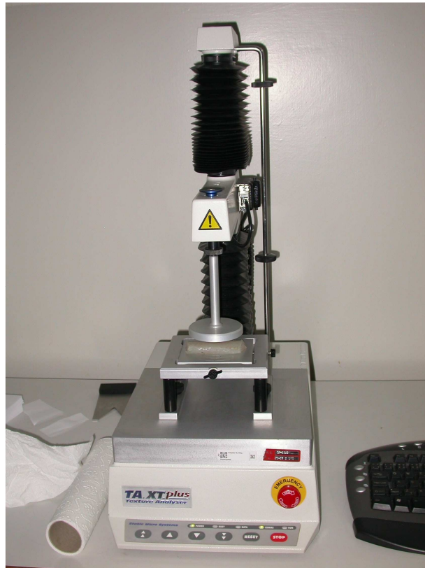
Příloha č.9. Texturometr značky TA.XT. plus
