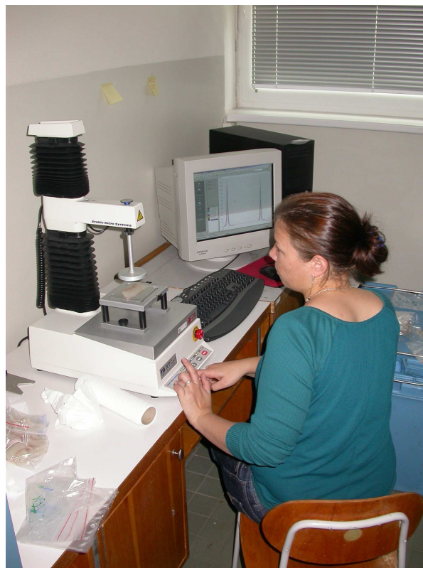
Příloha č.10. Mechanické měření textury svaloviny pomocí texturometru
