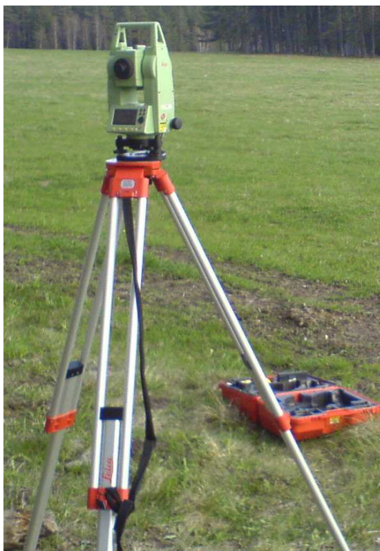
Obr. 11 Totální stanice Leica TC407
