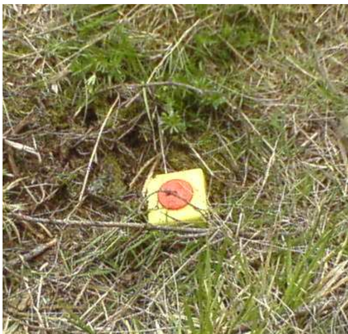
Obr. 10 Zatlučený mezník s plastovou hlavou
