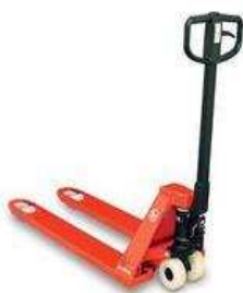
Obrázek 2 Paletový vozík se sníženou výškou vidlic
