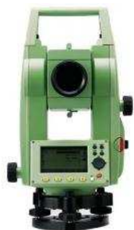
Obr. 8: ukázka použitého přístroje při měření - totální stanice Leica TC 407. [36]
