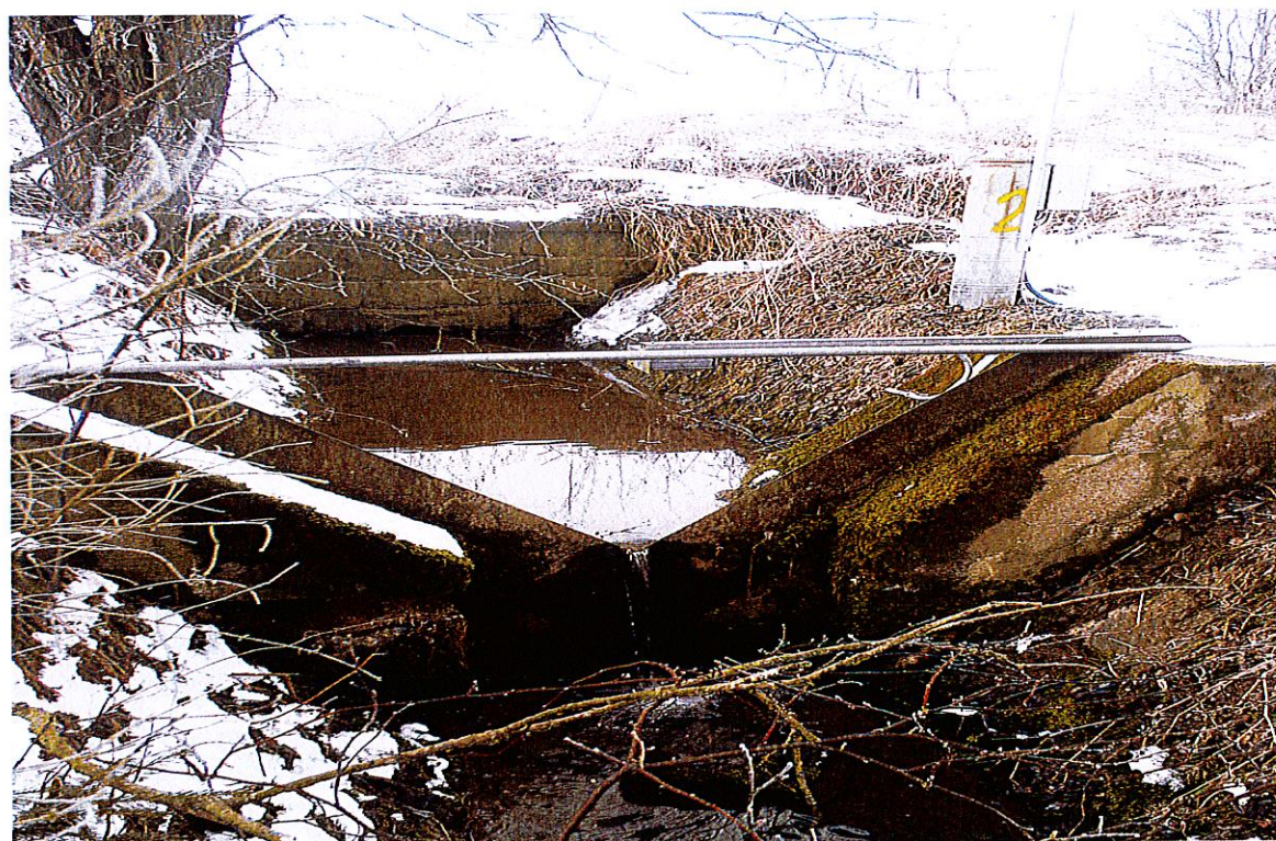
Obr. 2: Ultrazvukové čidlo na sporadické drenáži Jenín 1
