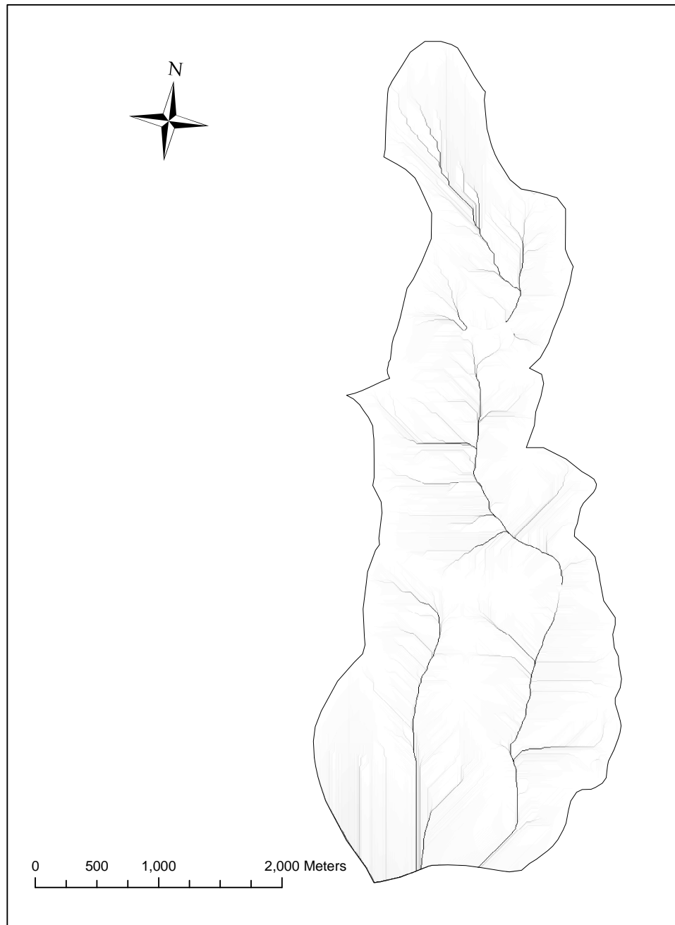
Obr. č. 5.11 Dráhy soustředěného povrchového odtoku
