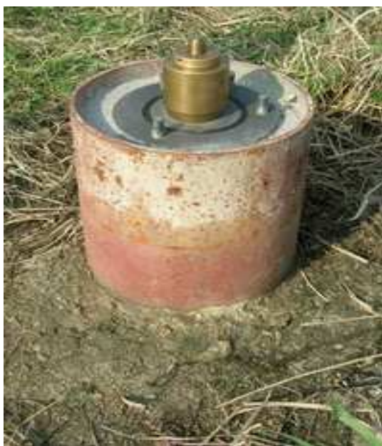
Obr. 7: Stabilizace bodu se zasunutým centračním přípravkem
