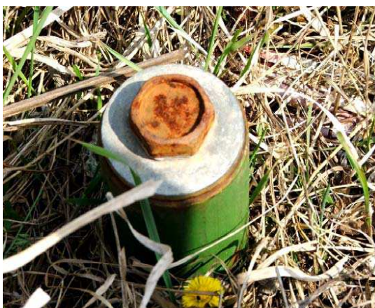
Obr. 8: Stabilizace podrobného bodu
