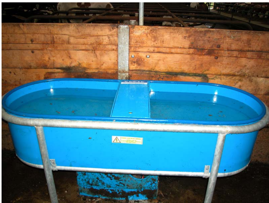
Obr. 5 Stáj A – Kapacitní napájecí žlab temperovaný KNŽT 1800
