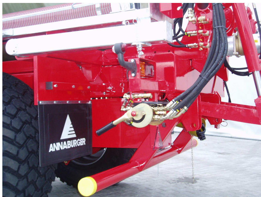
Příloha č. 11 Zapojení hydrauliky – jedna páka (převzato z CRS-Marketing, 1999).
