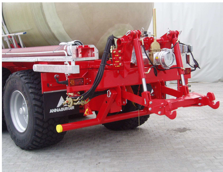
Příloha č. 13 Jednoduché zapojení třibodového závěsu, jen dva čepy (převzato z CRS-Marketing, 1999).
