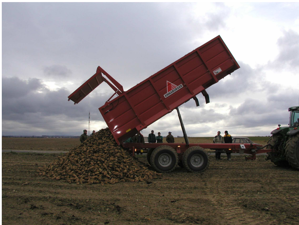
Příloha č. 7 Čelo jde do 4,8 m výšky, spoiler se odklopí, robustní čelo (převzato z CRS-Marketing, 1999).
