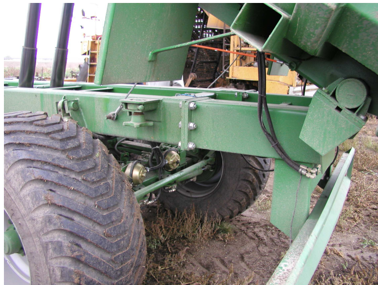
Příloha č. 4 Detail nutnosti odpojení rámu od korby a absence odstavných noh (převzato z PaL, 2005).
