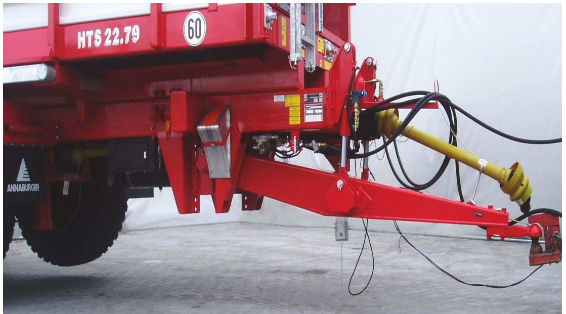
Příloha č. 9 Hydraulicky odpružená oj, dvě hadice –tlaková a zpátečka, dvě další hadice na oj (převzato z CRS-Marketing, 1999).
