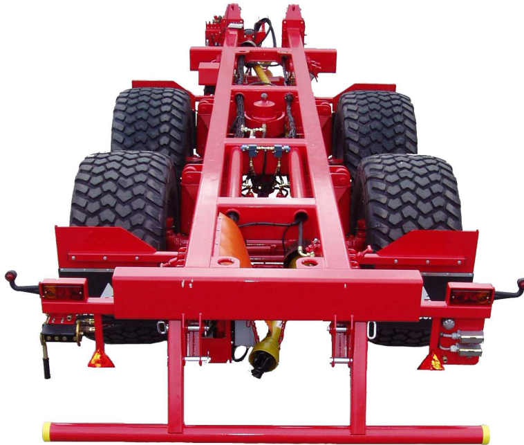
Příloha č. 1 Detail podvozku Annaburger s odklopným zadním spoilerem (převzato z CRS-Marketing, 1999).
