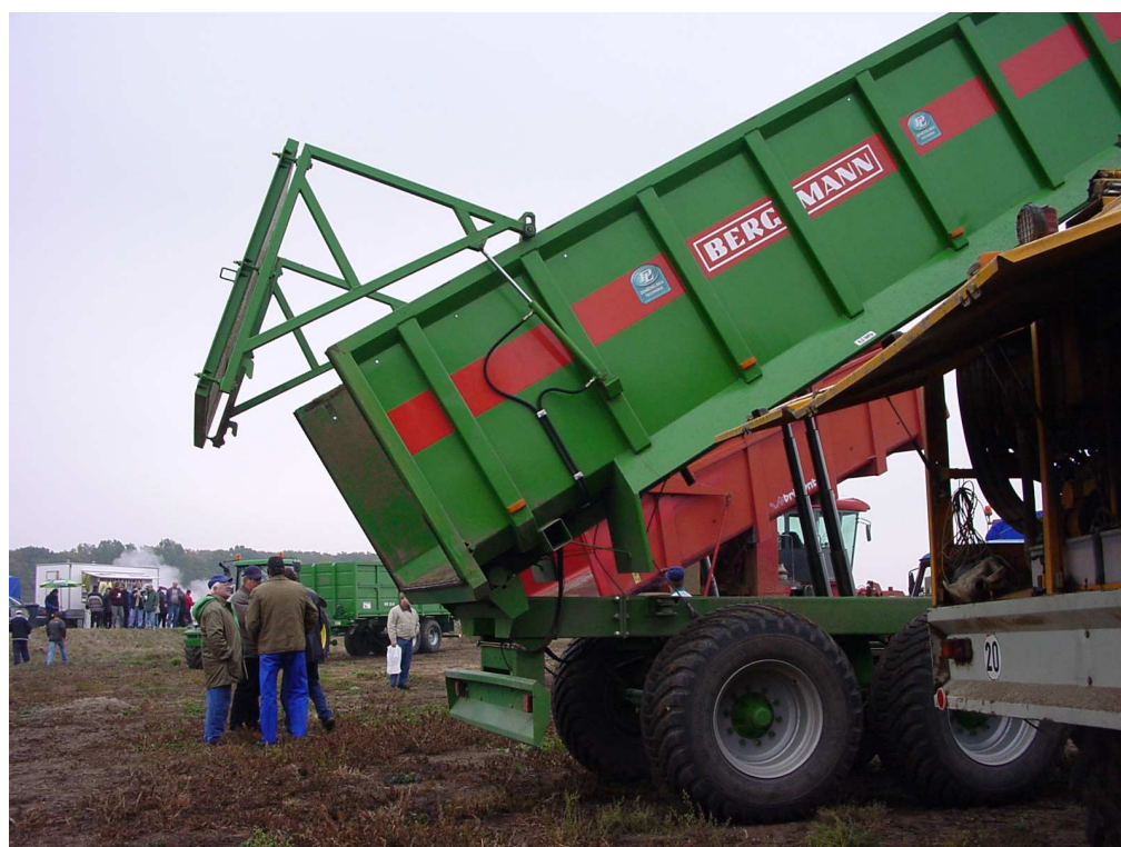
Příloha č. 7 Čelo jde do 4,8 m výšky, spoiler se odklopí, robustní čelo (převzato z CRS-Marketing, 1999).
