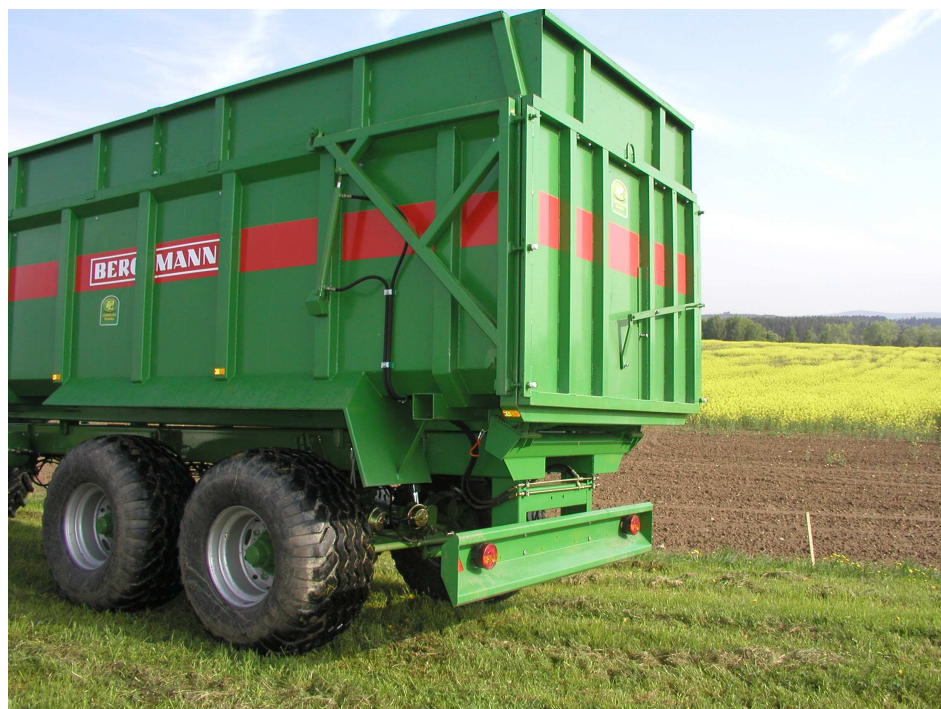
Příloha č. 2 Detail podvozku Bergmann s pevným zadním spoilerem (převzato z PaL, 2005).
