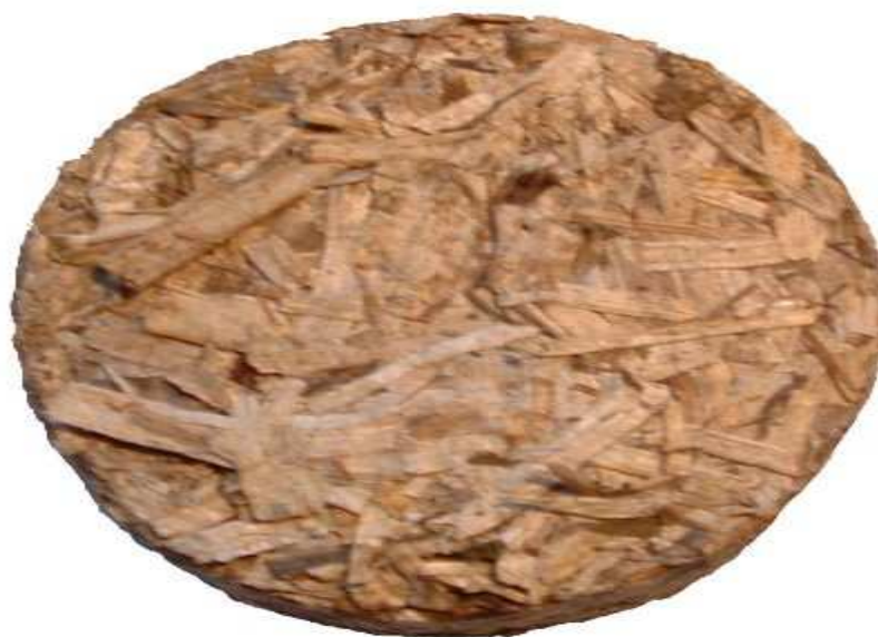
Obr. č. 6 Briketa z konopného pazdeří, briketa má průměr 65 mm (Plíštil 2004)
