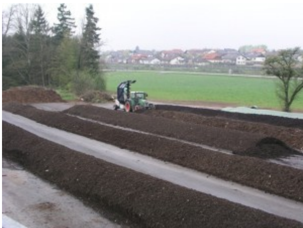
obr. č. 2 Stálá kompostárna na volné, vodohospodářsky zabezpečené ploše
